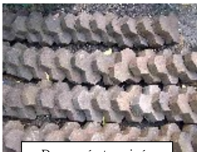
Des pavés terminés
